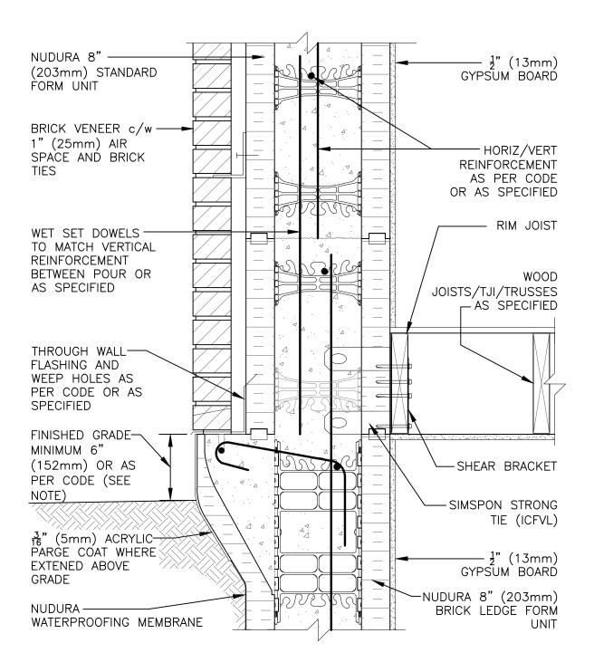
NOTE: FINISHED GRADE LEVEL SPECIFIED FOR FROST PRONE AREAS. FOR ALTERNATIVE GRADE LEVEL SEE DETAIL C6A34
