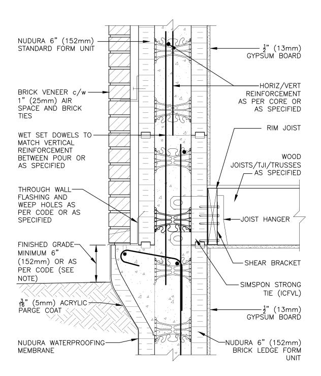
NOTE: FINISHED GRADE LEVEL SPECIFIED FOR FROST PRONE AREAS. FOR ALTERNATIVE GRADE LEVEL SEE DETAIL C6A31
