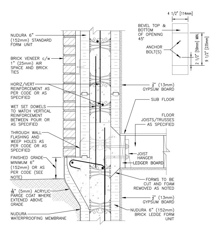
NOTE: FINISHED GRADE LEVEL SPECIFIED FOR FROST PRONE AREAS. FOR ALTERNATIVE GRADE LEVEL SEE DETAIL C6A32
