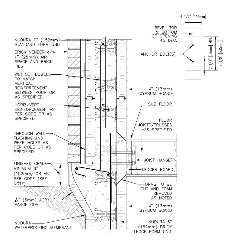
NOTE: FINISHED GRADE LEVEL SPECIFIED FOR FROST PRONE AREAS. FOR ALTERNATIVE GRADE LEVEL SEE DETAIL C6A29
