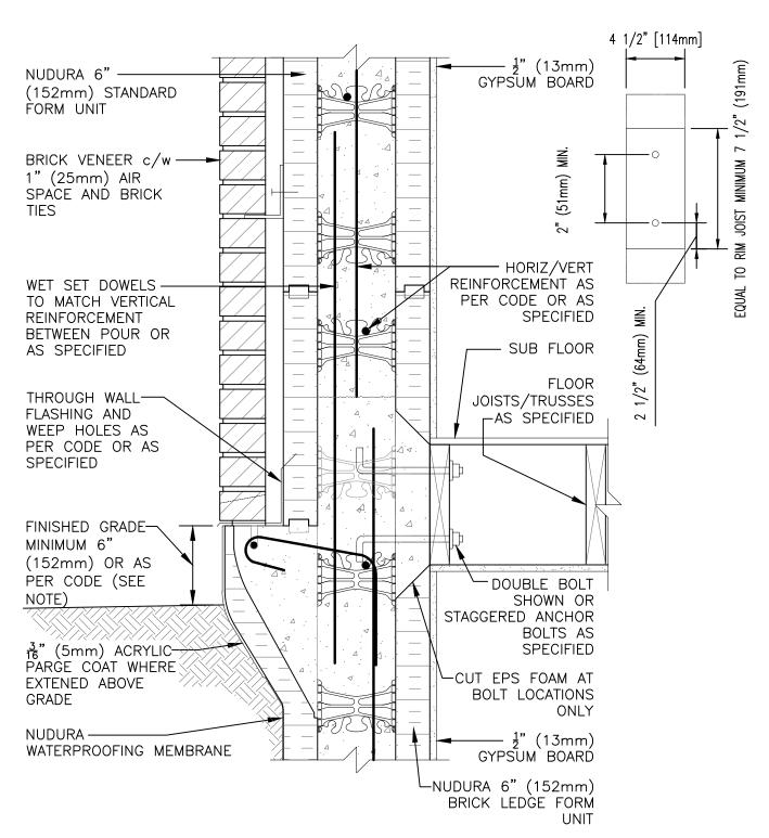
NOTE: FINISHED GRADE LEVEL SPECIFIED FOR FROST PRONE AREAS. FOR ALTERNATIVE GRADE LEVEL SEE DETAIL C6A33
