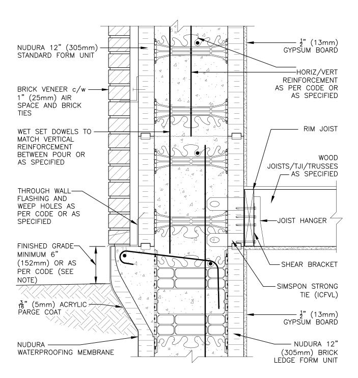
NOTE: FINISHED GRADE LEVEL SPECIFIED FOR FROST PRONE AREAS. FOR ALTERNATIVE GRADE LEVEL SEE DETAIL C6A31
