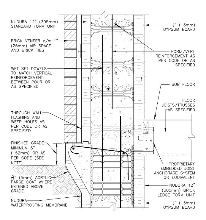
NOTE: FINISHED GRADE LEVEL SPECIFIED FOR FROST PRONE AREAS. FOR ALTERNATIVE GRADE LEVEL SEE DETAIL C6A30
