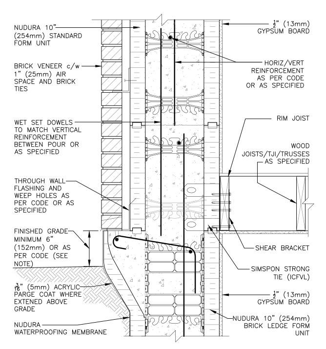
NOTE: FINISHED GRADE LEVEL SPECIFIED FOR FROST PRONE AREAS. FOR ALTERNATIVE GRADE LEVEL SEE DETAIL C6A34
