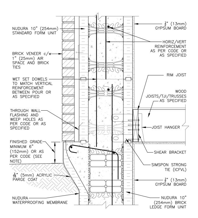
NOTE: FINISHED GRADE LEVEL SPECIFIED FOR FROST PRONE AREAS. FOR ALTERNATIVE GRADE LEVEL SEE DETAIL C6A31
