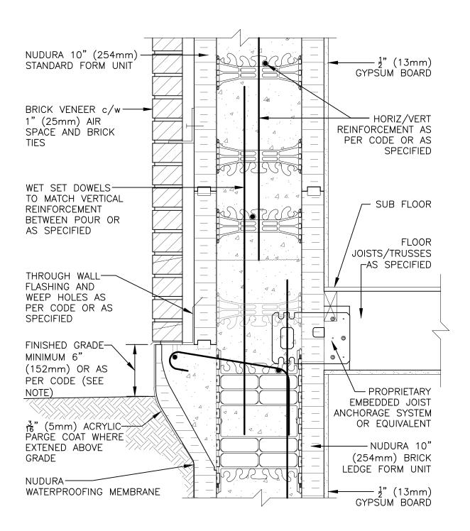
NOTE: FINISHED GRADE LEVEL SPECIFIED FOR FROST PRONE AREAS. FOR ALTERNATIVE GRADE LEVEL SEE DETAIL C6A30
