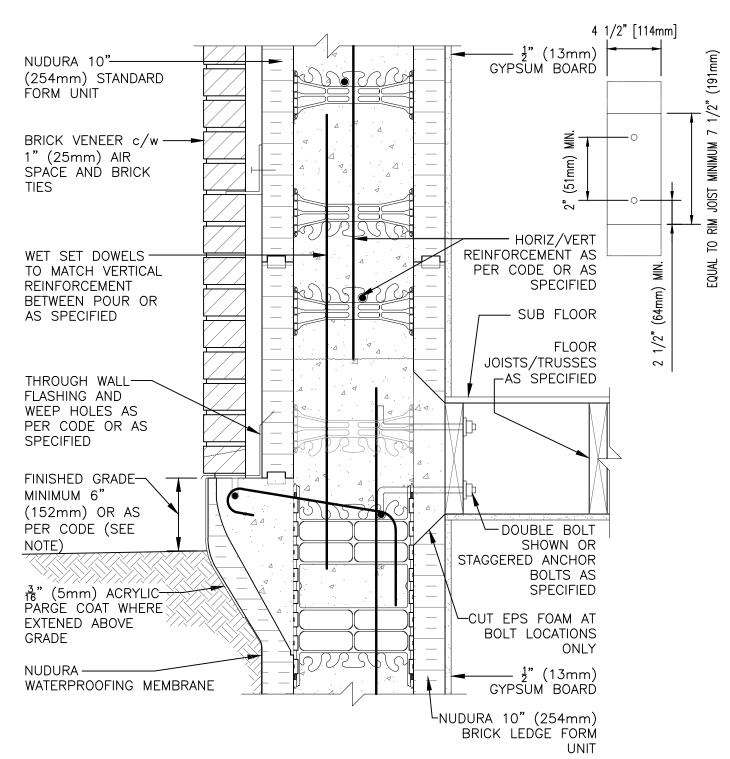
NOTE: FINISHED GRADE LEVEL SPECIFIED FOR FROST PRONE AREAS. FOR ALTERNATIVE GRADE LEVEL SEE DETAIL C6A33
