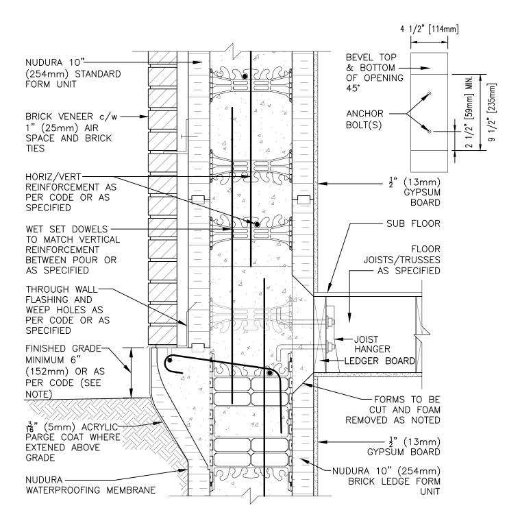
NOTE: FINISHED GRADE LEVEL SPECIFIED FOR FROST PRONE AREAS. FOR ALTERNATIVE GRADE LEVEL SEE DETAIL C6A32
